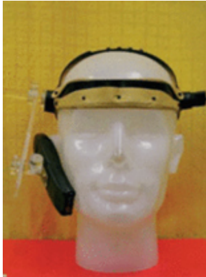
Abbildung 2: Kopfphantom für die Bestimmung des SAR-Wertes. Bildquelle [13]
