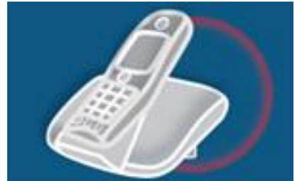
Moderne Schnurlostelefone bieten einen ECO Mode an. Wenn dieser aktiviert ist, so strahlt die Basisstation im Ruhezustand nicht oder nur sehr reduziert. Zudem lässt sich bei einigen Modellen die Reichweite der Basisstation (und so die Strahlungsstärke) reduzieren. Während des Gesprächs wird die Strahlung des Hörers (und zum Teil der Basisstation) dynamisch, je nach Verbindungsqualität (Distanz zwischen Hörer und Basisstation) reduziert.
