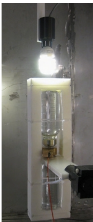
Abbildung 2: Phantom mit Flüssigkeit im elektrischen Feld der Energiesparlampe. Die im Phantom erzeugten Ströme werden mit Hilfe der Klammer in der Mitte gemessen. Der Abstand zwischen der Lampe und dem Phantom beträgt 2 cm.
