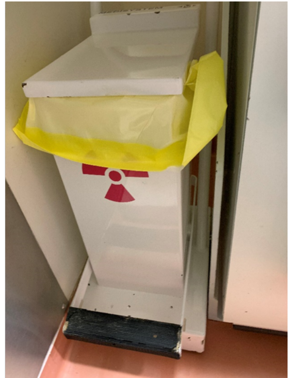
Abbildung 7: Abgeschirmte Behälter für die aktivsten Abfälle in der Nuklearmedizin
