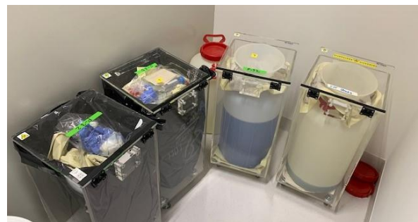
Abbildung 11: Abklinglagerung von festen und flüssigen Abfällen aus einem Forschungslabor. Die Behälter für flüssigen Abfall stehen in Auffangwannen.
