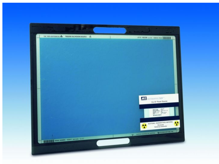
Abb.4: Co-57 Flächenquelle für Homogenitätskontrolle
