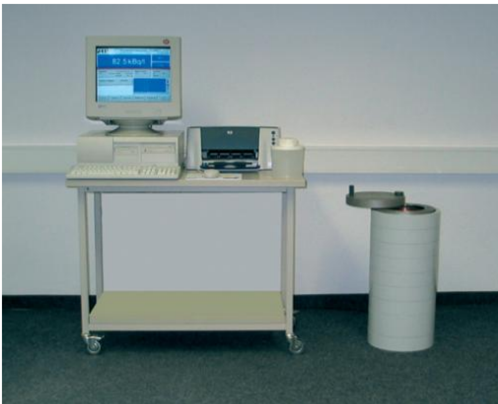
Abbildung 5: Abwassermessplatz zur Bestimmung der Aktivität
