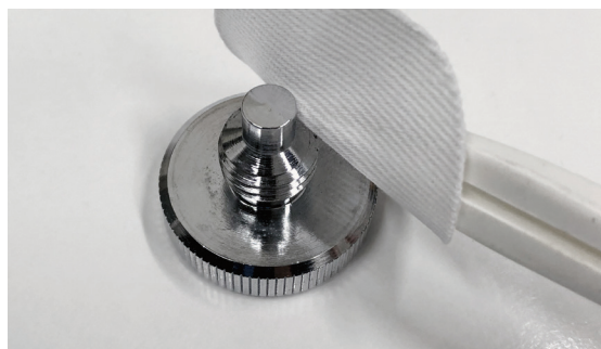
Prelievo del campione direttamente sulla sorgente utilizzando un filtro per la prova di strofinamento.
