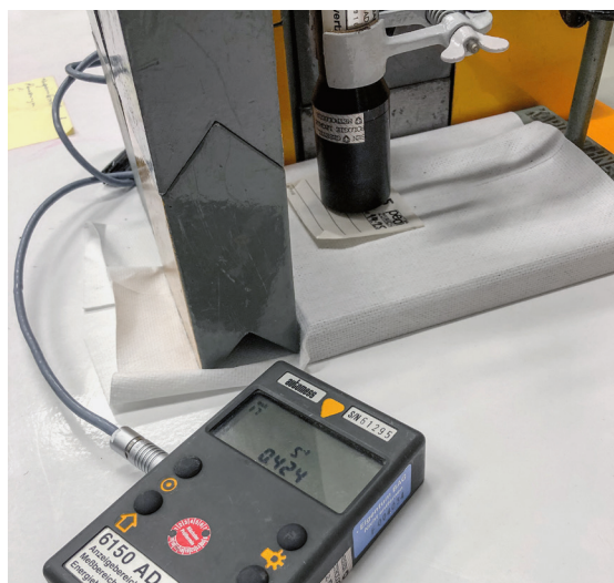
Misurazione del campione in una zona di misurazione schermata con geometria di misura fissa.
