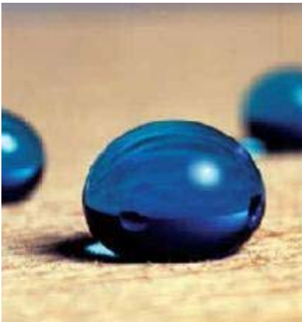
Abb. 6 > Wassertropfen auf einer behandelten, superhydrophoben Holzoberfläche.
